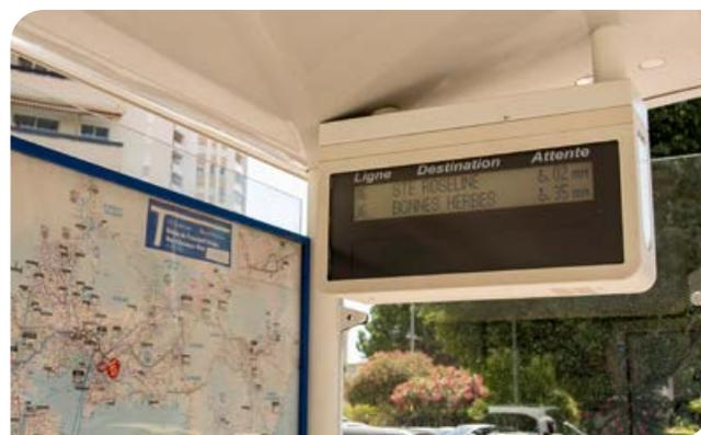
Une BIV (Borne d'Information Voyageurs) ou un PIV (Poteau d'Information Voyageurs) est un système dynamique qui permet d'informer l'usager des prochains horaires de passage à l'arrêt ou des perturbations de réseau. Cette information peut être mise à jour en temps réel.
