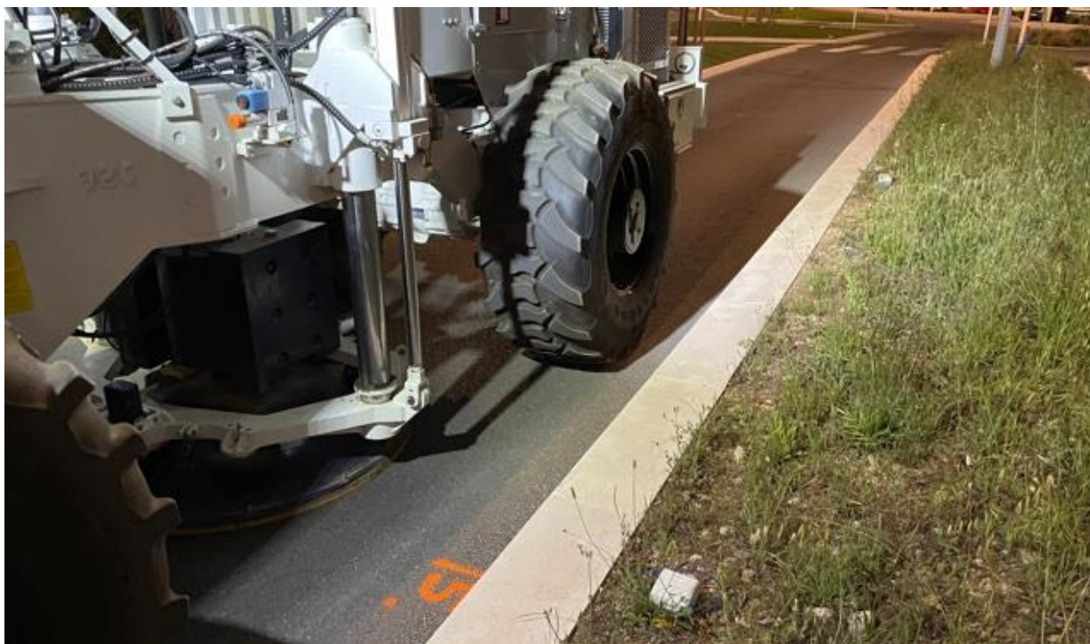
Figure 6 : Camion vibreur Envirovibe IVI Mark II sur le point de tir
